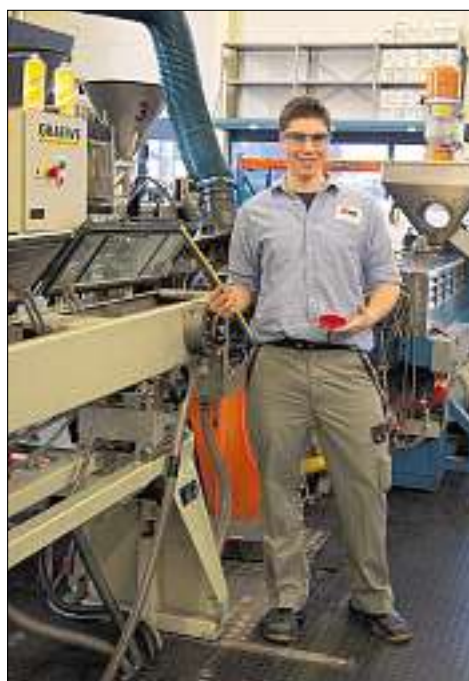
Emanuel Hirscher bei der Anlage zur Herstellung von Glattrohren. Diese werden zum Beispiel als Benzinleitungen eingesetzt.
