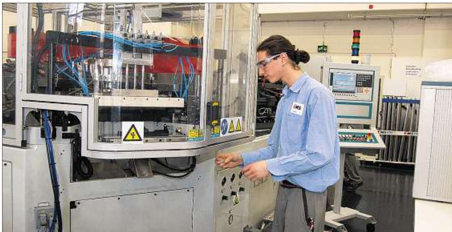
Sascha Gradolf, Lernender Kunststofftechnologie EFZ im zweiten Lehrjahr bei Ems, prüft spritzgeblasene Fläschchen. Solche Fläschchen können zum Beispiel zur Verpackung von Pharmazeutika dienen.
