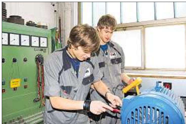
Manuel Willi, Lernender Elektroinstallateur EFZ im dritten Lehrjahr, prüft mit Gian Andrea Spescha, Lernender Automatikler EFZ im vierten Lehrjahr, die Wicklung eines Elektromotors.
